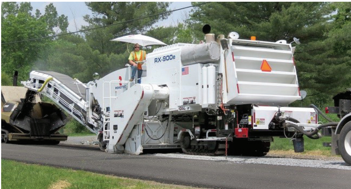
Зураг 14. Асфальт бетон хучилт хуулах машин механизм (Жишээ зураг)
