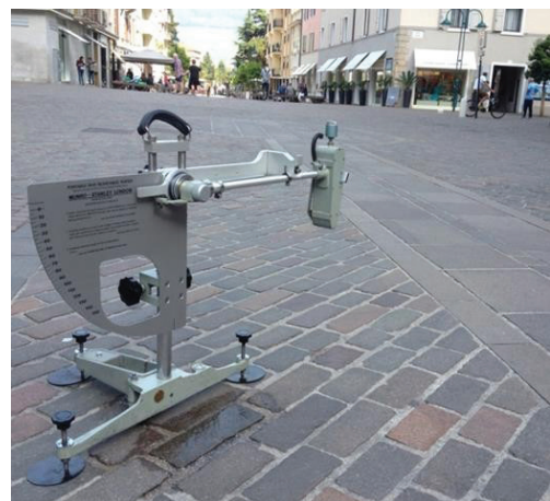
Зураг 28. Дүүжин багаж (British Pendulum) (Жишээ зураг)
