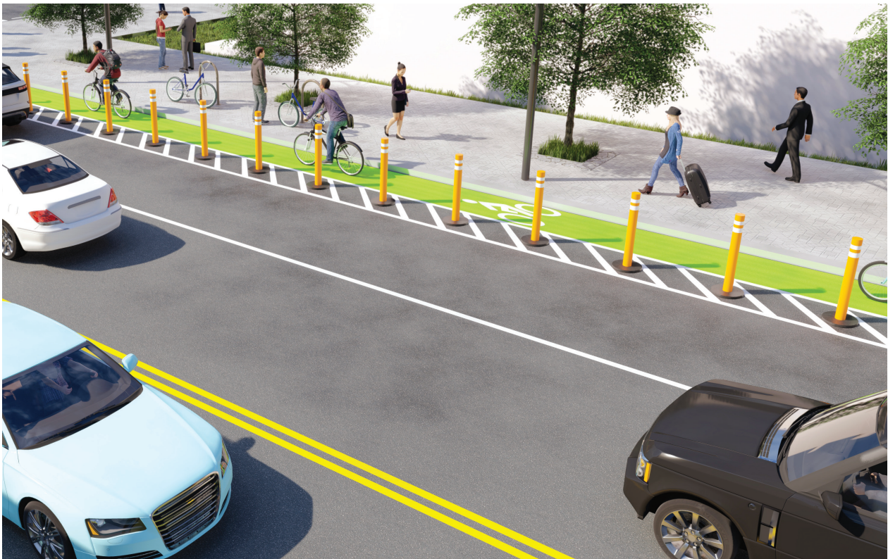
Зураг 32. Тусгаарлах зурвас, чиглүүлэх хэрэгслээр хамгаалагдсан унадаг дугуйн замын харагдах байдал (Жишээ зураг)
